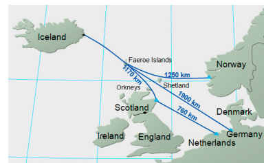
Denkbare Routen eines Stromunterwasserkabels von Island.
